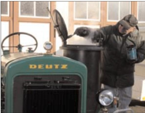
Ein Holzvergaser macht schon mal etwas mehr Mühe. Alfons Jung dichtet die Einfüllöffnung des Gasgenerators mit einer Öl-Grafit-Paste ab.
