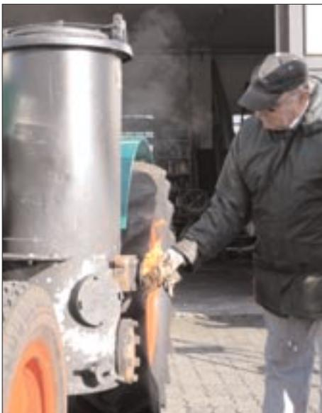
Durch die Luftansaugöffnung wird Feuer gelegt. Das Anfachgebläse sorgt für den Luftzug.
